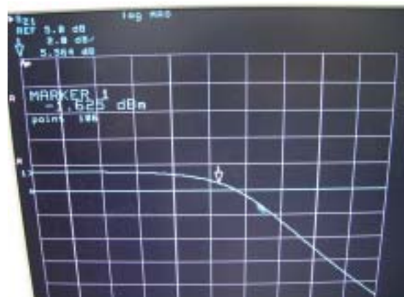
圖 4.32 增益壓縮圖 \rightarrow -1 dBm
