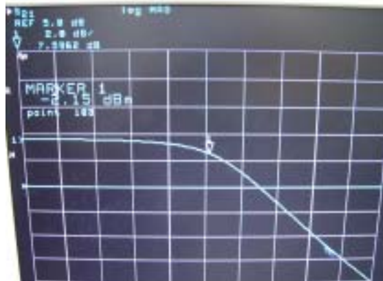
圖 4.40 增益壓縮圖 \rightarrow -2 dBm
